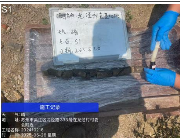
图 4-5 土壤 VOCs 样品采集
